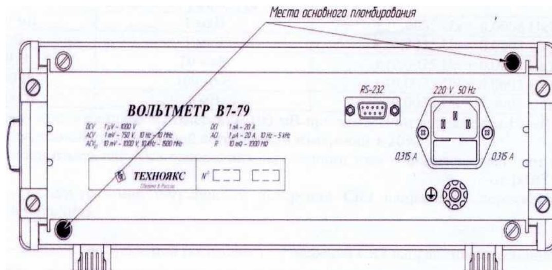
Рисунок 2 - Схема пломбировки от несанкционированного доступа
