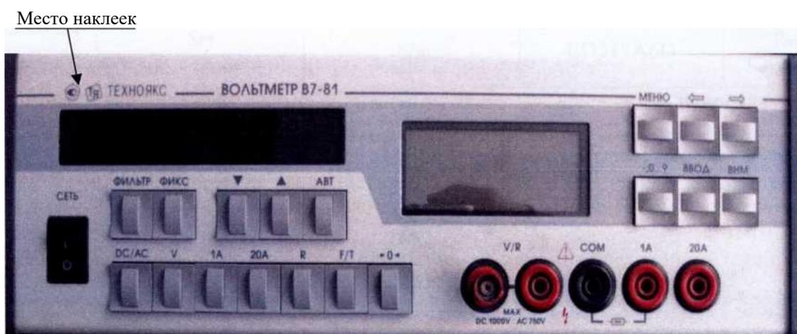
Рисунок 1 - Внешний вид вольтметра универсального В7-81
